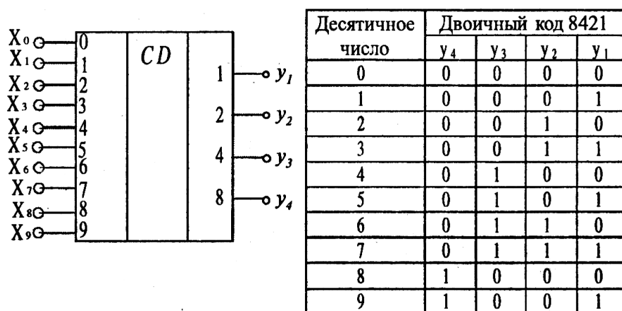
Рис. 18. Схема шифратора и таблица соответствия кода
